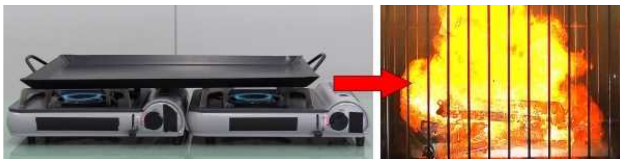
カセットボンベが過熱され、破裂した再現実験
