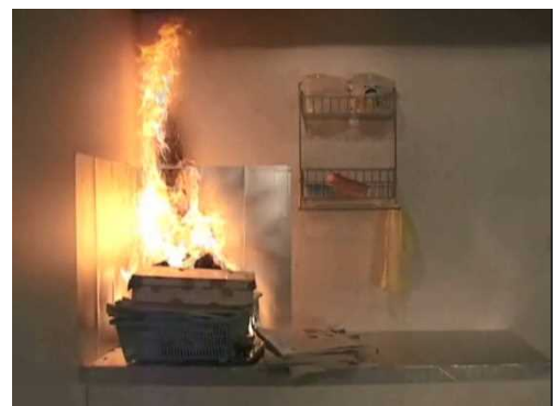
電気こんろ上の可燃物が発火 (再現実験)
