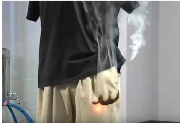
残火に気づかずポケットに入れた事故の再現実験
